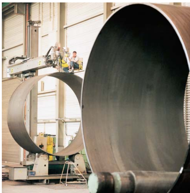
Wytwarzanie wież elektrowni wiatrowych przy pomocy systemu słupowysięgników
